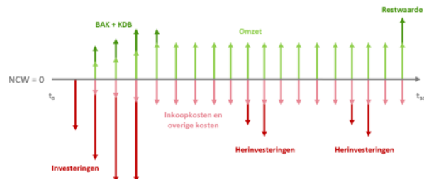
Figuur 4 : Schematische weergave van de kasstromen die onderdeel zijn van de NCW-berekening van een warmtenetproject.
