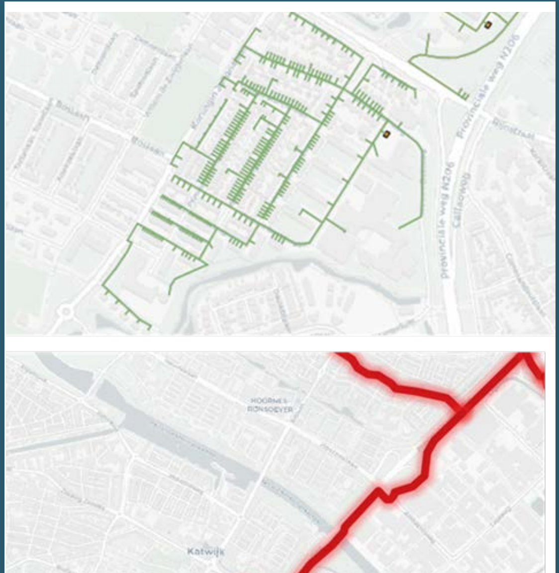
Distributienet: hoofdleiding (onder) en seceundair net (boven)
